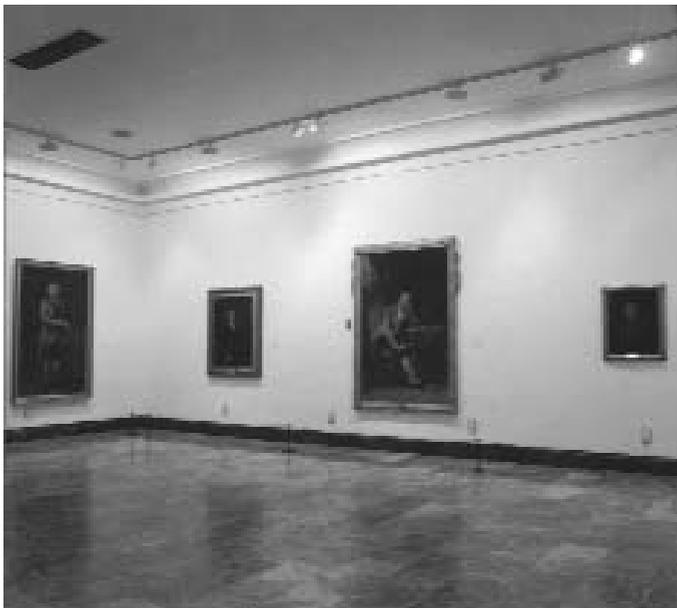
FIG. 206. Detalle del sistema de iluminación mediante carril continuo y bañadores de pared. (Fot. MZ. J. Garrido).
