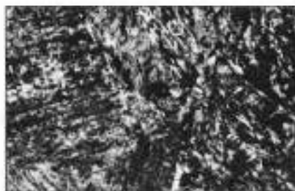
FIG 8,2. Micrografía de la pieza núm. 14. Ataque Nital. X 500.
