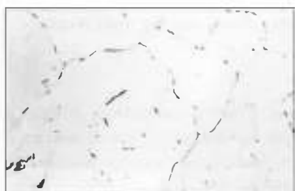
FIG 4,5. Micrografía de la pieza núm. 7. Ataque Nital. X 500.
