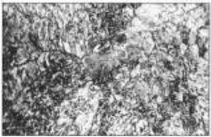
FIG. 4,3. Micrografía de la pieza núm. 5. Ataque Nital. X 500.
