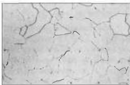
FIG. 2,2. Micrografía de la pieza núm. 2. Ataque Nital. X 200.
