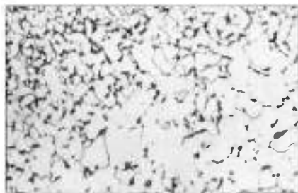
FIG. 1,2. Microestructura de la pieza núm. 1. Ataque Nital. X 200.
