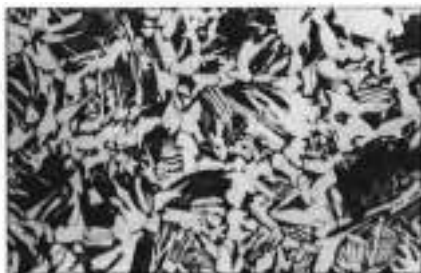
FIG. 1,5. Micrografía de la pieza núm. 2. Ataque Nital. X 200.
