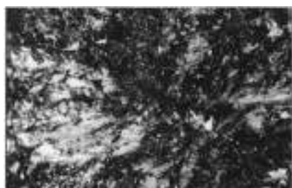
FIG 8,5. Micrografía de la pieza núm. 15. Ataque Nital. X 200.
