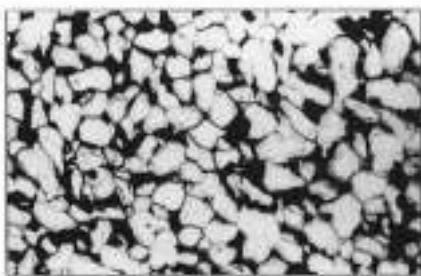
FIG. 1,3. Microestructura de la pieza núm. 1. Ataque Nital. X 500.
